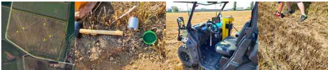
Figura 1: Da sinistra a destra: esempio di schema di campionamento suolo; prelievo per determinazione della densità di suolo; sistema di campionamento del suolo; valutazione dei residui colturali
